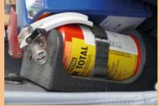
Der Halonlöscher befindet sich links neben dem Pilotensitz an der Mittelkonsole.
