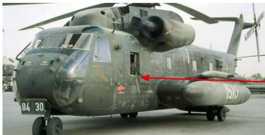
Hinter dem Cockpit befindet sich auf der linken Seite ein Notzugang. Vorsicht bei eingebautem Maschinengewehr!
