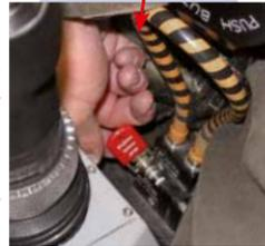
In der GS-Version (Einsitzer) wird die Kabinenabwurfanlage links hinter dem Sitz mit dem Sicherungsstift gesichert.
