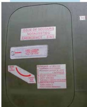
Zusätzlich befindet sich eine Ausstiegsluke rechts hinter dem Cockpit nach hinten versetzt. Diese Luke führt in den Passagier- und Laderaum.
