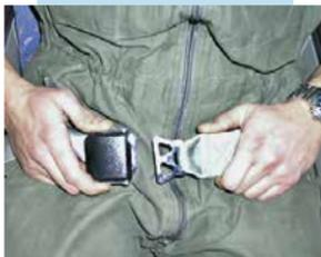
Die Gurte der Passagiere werden durch Anheben des Öffnungsbügels geöffnet.
