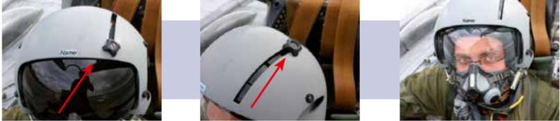
1| Verriegelungsknopf für das Sonnensvisier lösen und Visier nach hinten schieben.
