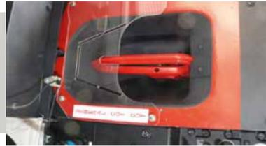
Durch Ziehen dieser roten Griffe (im Cockpit jeweils über den Köpfen der Piloten) wird die Kraftstoffzufuhr und die komplette elektrische Versorgung unterbrochen.
