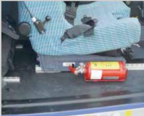
Der Halonlöscher befindet sich rechts neben dem Pilotensitz.
