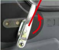
Die Schiebetüren rechts und links durch Drehen des Türgriffes nach oben entriegeln und dann nach hinten schieben.
