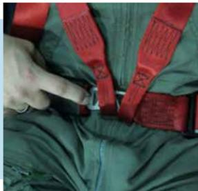
Die Gurte der Passagiere werden (wie beim PKW) durch Drücken des Gurt-schlösses geöffnet.
