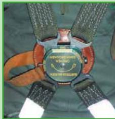
Zum Lösen der Modularen Rettungsweste mit integriertem Stehhaltegurt sind die beiden gelben Auslösegriffe nach unten zu ziehen.
