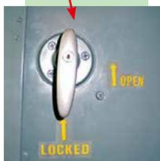
Die Schiebetüren rechts und links durch Drehen des Türgriffes entriegeln und nach hinten schieben.
