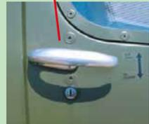
Die Cockpittüren rechts und links lassen sich durch Drehen des Türgriffes in die OPEN-Position öffnen.
