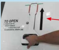
Aktivierungshebel durch Greifen in die Klappe...
