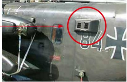
Die Selbstschutzanlage befindet sich am Rumpf hinten (rechts und links) und vorne an den Sponsons (rechts und links).
