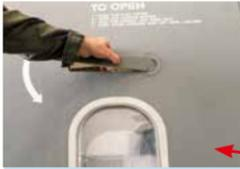
Den Öffnungsgriff durch Eindrücken der Klappe und Betätigen des Druckknopfes herausziehen ...
