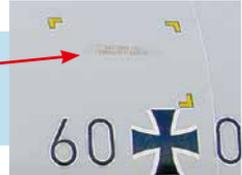
Einschlagzonen befinden sich nur rechts hinter der Rumpfmittle, hinter und oberhalb dem Tragflächenende und sind gelb gekennzeichnet.
