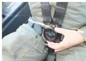
Die Gurte der Crew werden durch eine Drehung des Zentralschlusses geöffnet.
