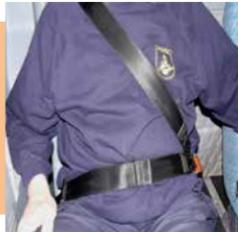
Das Gurtschloss der Passagiere wird mit einem Druck auf die Schloßsperre geöffnet.
