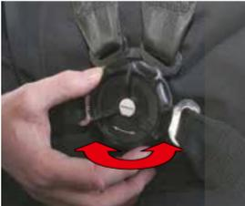
Das Gurtschloss der Piloten wird mit einer 90° Drehung geöffnet.
