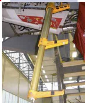
Der EUROFIGHTER ist mit einer fest am Luftfahrzeug installierten Bordleiter ausgerüstet. Zur Nutzung ist neben dem CANOPY- Schalter der Vierkantkopfschalter zu betätigen (Bezeichnung »LADDER«).
