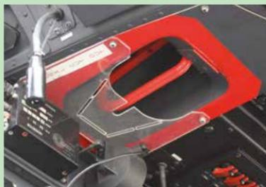
Durch Ziehen dieser roten Griffe (im Cockpit jeweils über den Köpfen der Piloten) wird die Kraftstoffzufuhr und die elektrische Versorgung der Triebwerke unterbrochen.
