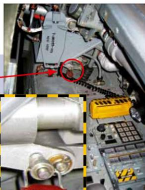
Dieser Stift gehört in die gekennzeichnete Buchse hinter der linken Konsole etwas hinter dem Schleudersitz.
