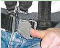
Zum Öffnen der Gurte wird der Deckel des Gurtschlusses angehoben.
