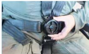
Die Gurte der Crew werden durch eine Drehung des Zentralschlosses geöffnet.
