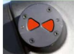
Dieses Symbol zeigt an, dass sich die Waffen in einem **ungesicherten Zustand** befinden.
