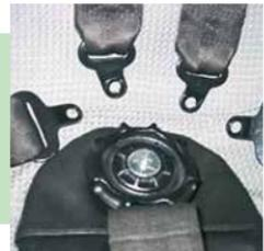
Alle Passagiere haben einen Vier-Punkt-Sicherheitsgurt. Das Gurt-zentralschloss wird mit einer 90°-Drehung des Drehgriffes geöffnet.
