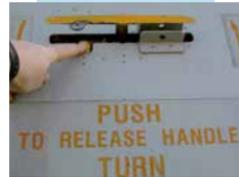
Diesen Hebel um 90 Grad in Pfeilrichtung drehen und die Tür nach innen schieben.
