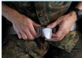
Die Gurte der Passagiere werden durch Anheben des Öffnungsbügels geöffnet.
