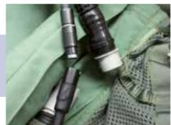
**4** Den Schlauch für die Sauerstoffversorgung am Schnellanschluß zusammendrücken, drehen und trennen.
