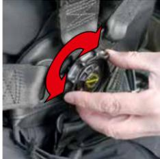
Das Gurtschloss der Piloten wird mit einer 90° Drehung geöffnet.
