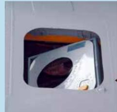
Eine Notausstiegs Luke für das Cockpit ist nur auf der linken Seite vorhanden und wird durch Eindrücken des gelb gekennzeichneten Knopfes nach innen geöffnet.
