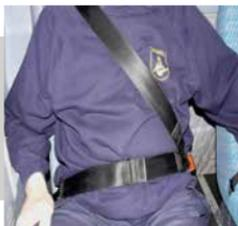
Das Gurtschloss der Passagiere wird mit einem Druck auf die Sperre geöffnet.
