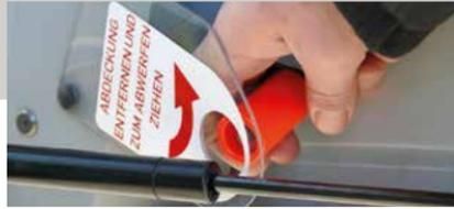
Tür öffnen, hinter die entsprechende Kunststoffabdeckung greifen und diese entfernen. Griff in Pfeilrichtung ziehen.
