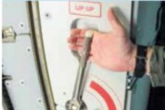
Die Fallschirmspringerplattformen durch Führen des Hebels in Pfeilrichtung absenken.
