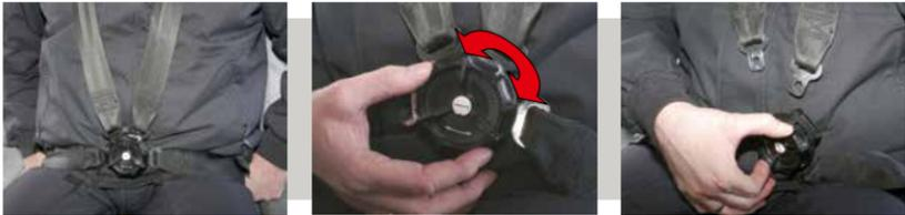
Das Gurtschloss wird mit einer 90° Drehung geöffnet.
