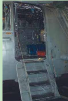
Dieser zweigeteilte Eingang wird beginnend mit dem Unterteil geöffnet und nach außen geklappt.
