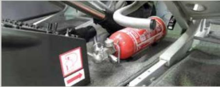
Der Halonlöscher befindet sich am Kabinenboden zwischen den Frontsitzen.
