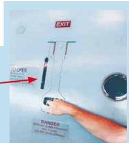
Aktivierungshebel durch Greifen in die Klappe...
