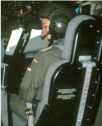
Um die Piloten zu erreichen muss zuerst der Sitz des Bordmechanikers nach hinten geschwenkt werden.
