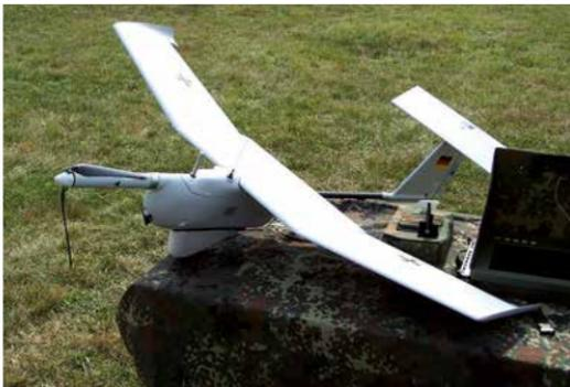
Das unbemannte Luftfahrzeug ALADIN wird durch einen Elektromotor angetrieben und ist relativ klein.
