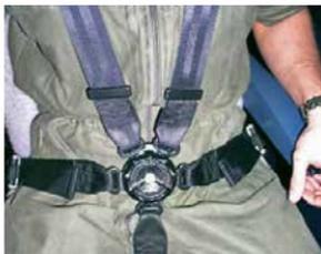
Die Gurte der Crew werden durch eine Drehung des Zentralschlosses geöffnet.
