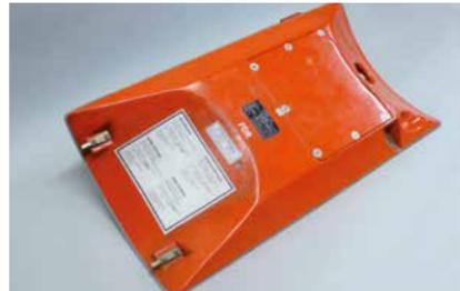
Beim PA 200 TORNADO ist der Digitalspeicher von aussen entsprechend der Farbe des Luftfahrzeuges, von innen jedoch orange.
