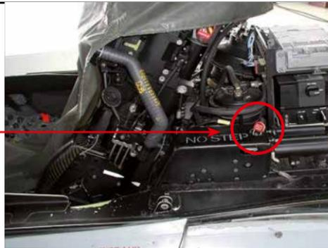
In der GT-Version (Doppelsitzer) wird die Kabinenabwurfanlage im Cockpit linke Konsole ganz hinten mit dem Sicherungsstift gesichert.
