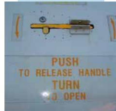
Zum Öffnen der Tür muss der gelb gekennzeichnete Entriegelungsknopf gedrückt werden und der Entriegelungshebel springt hervor.
