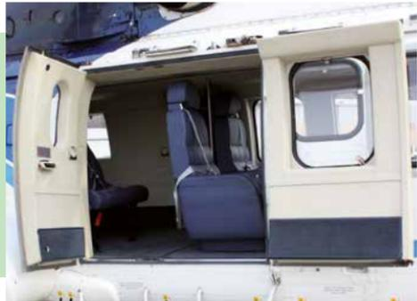
Zum Öffnen des rechten Türflügels den Griff eindrücken und in Richtung OPEN drehen. Der rechte Türflügel lässt sich jetzt öffnen.
