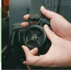
Die Crew ist mit einem Fünf-Punkt-Sicherheitsgurt-System ausgestattet. Zum Öffnen den Drehgriff am Zentralschloss um 90° drehen
