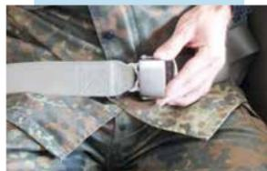
Die Gurte der Passagiere werden durch Anheben des Öffnungsbügels geöffnet.
