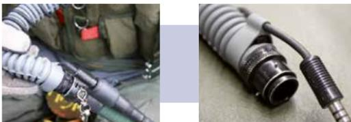
4| Den Schlauch für die Sauerstoffversorgung am Schnellanschluß zusammendrücken, drehen und trennen. Das Kabel für die Sprechverbindung einfach trennen.
