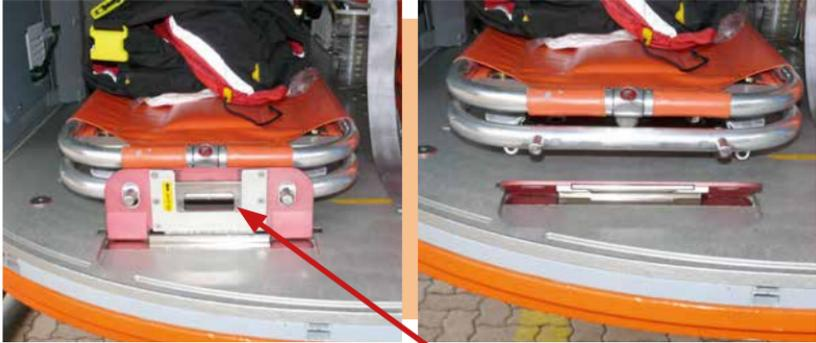
Mit der Hand das Sicherungsblech greifen, Sperre anheben und umklappen.
