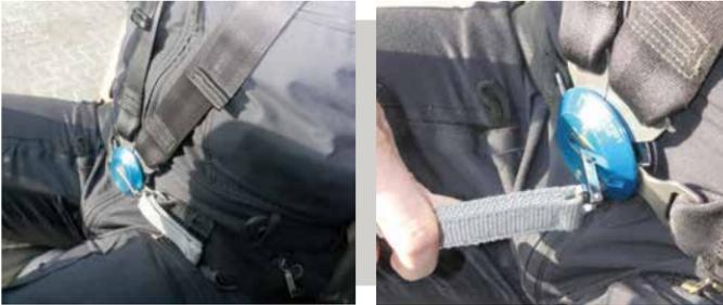
Die Vier-Punkt-Gurte der Piloten werden mit einem Zug an der Lasche vom Körper gelöst.
