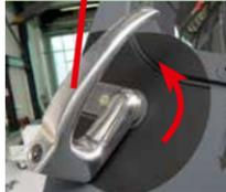
Die Cockpittüren rechts und links lassen sich durch Drehen des Türgriffes nach oben entriegeln und nach aussen hin öffnen.
