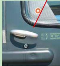
Die Schiebetüren rechts und links durch Drehen des Türgriffes nach oben entriegeln und dann nach hinten schieben.
