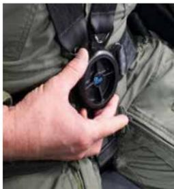
Die Gurte der Besatzung werden durch Drehung des Zentralschlösses geöffnet.
