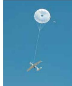
Das unbemannte Luftfahrzeug LUNA ist propellergetrieben und wird zu Aufklärungszwecken eingesetzt. Der Start erfolgt mit einem Startkatapult. Die Landung erfolgt in einem Netz oder an einem Fallschirm.
