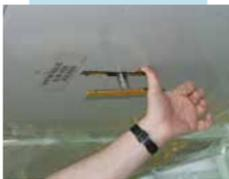
der Riegel springt hervor, um 90 Grad drehen und die Klappe seitwärts ins Innere schieben.
