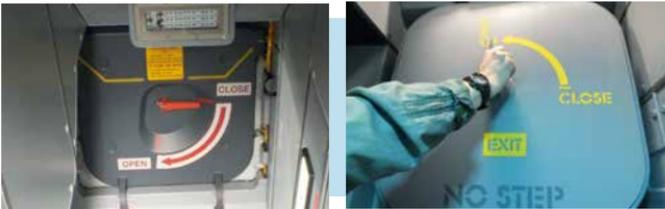
Die vordere Luke kann von innen und von außen durch Bewegungen des Griffes in Pfeilrichtung geöffnet werden.
