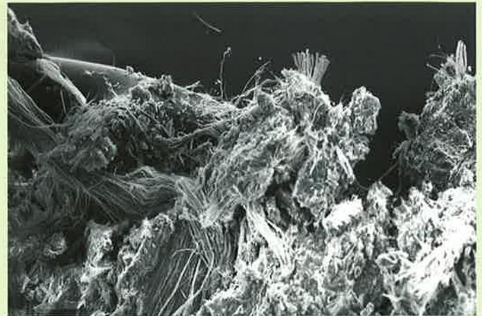
Abb. 4: Chrysotil, aufgenommen mit dem Rasterelektronenmikroskop
